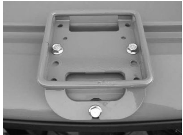
Support de fils sur le dessus de la cabine
