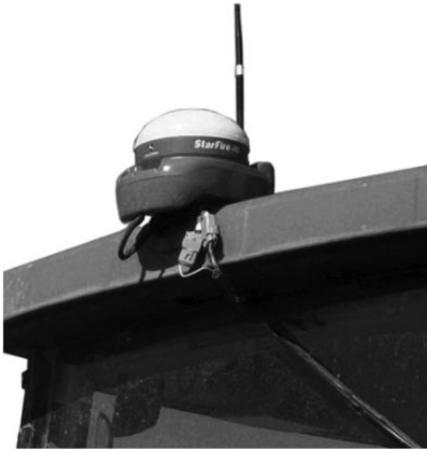
Récepteur RTK sur le dessus de la cabine
