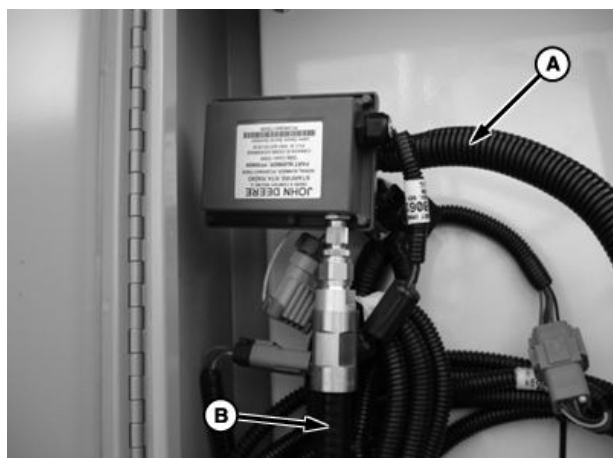
A —Câble RS232 de 91,4 m (300 ft) venant du récepteur B —Connexion du câble coaxial venant de l'antenne
